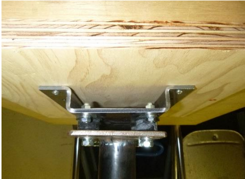
静荷重試験ゴム付 最大着地点
