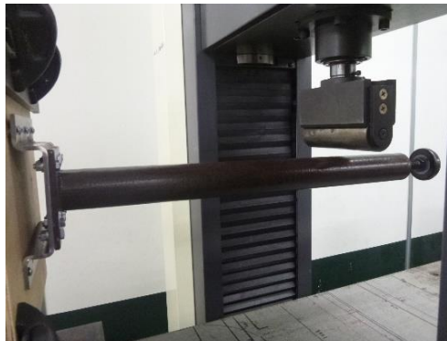
静荷重試験ゴム無 試験後戻らず
