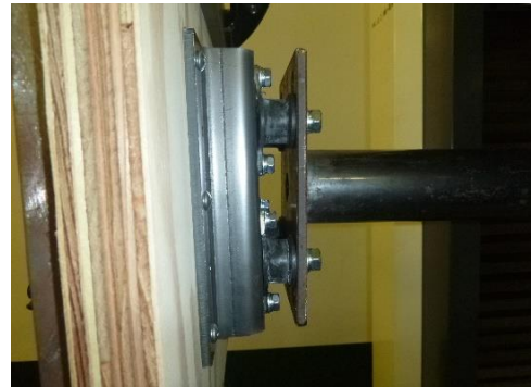
静荷重試験ゴム無 試験後戻らず
