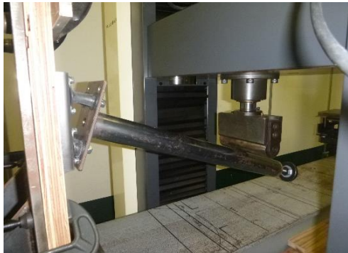
静荷重試験ゴム無 ビス抜け 1.39kN
