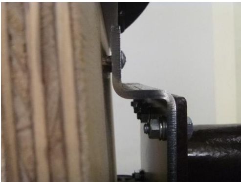
静荷重試験ゴム無 ビス抜け 1.39kN
